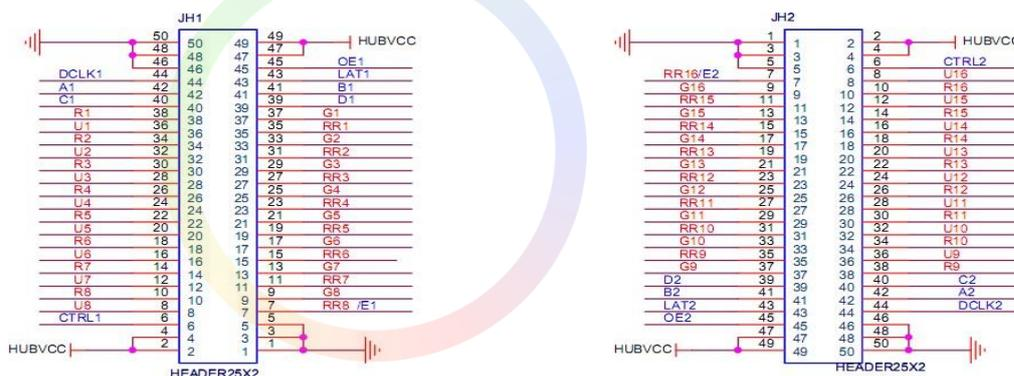
Виртуальный R сигнал в последней группе данных каждого 50-контактного концентратора является сигналом декодирования E в режиме сканирования 1/32.
