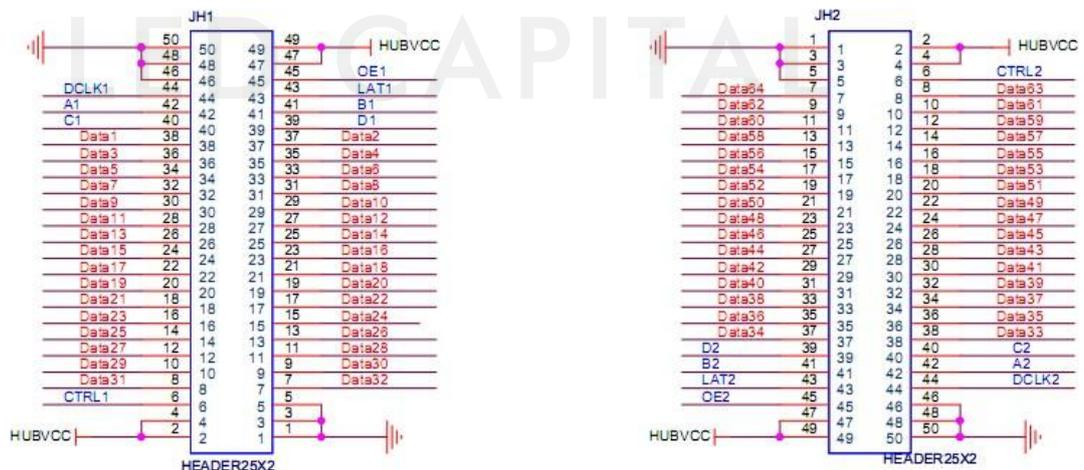
В последовательном режиме имеется 64 кабеля передачи данных. Каждый кабель может независимо управлять одной светодиодной полосой.
